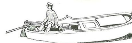
Embarcación rastreando a motor con lastre de gran peso y a mucha profundidad, con el timonel sentado sobre el cabo para poder sentir el roce del lastre por el fondo.
